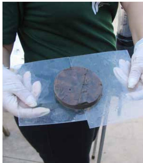
Figura 19. Lídia Cañas extrusionant el core curt en làmines per al seu estudi cronològic, biogeoquímic i taxonòmic. (Biel Obrador)
