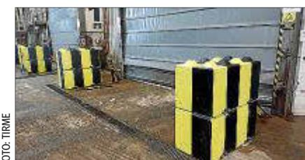
**Legos de hormigón reciclado.** Las instalaciones de Tirme producen legos de hormigón reciclado con las cenizas y escorias de la incineradora. • Página 18
